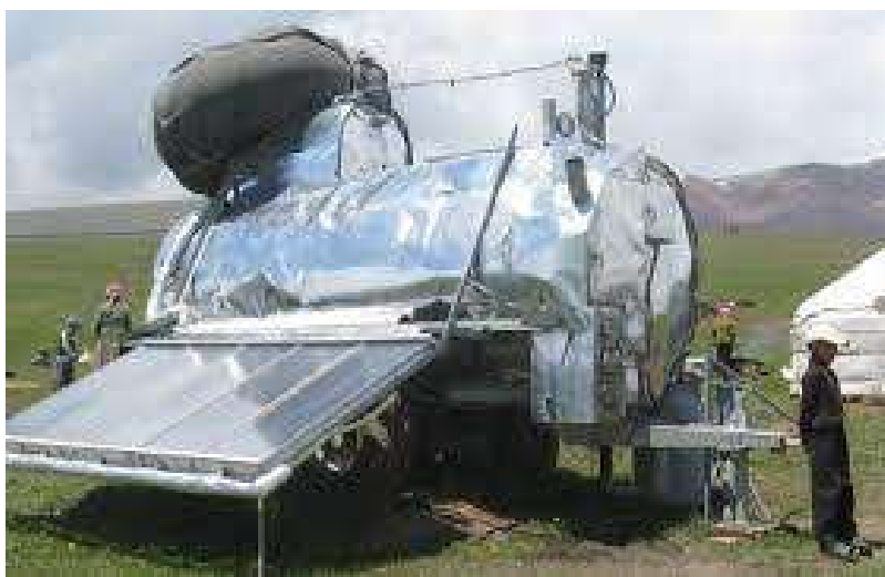
Рис.1. Передвижная биогазовая установка БЭМ-5М
