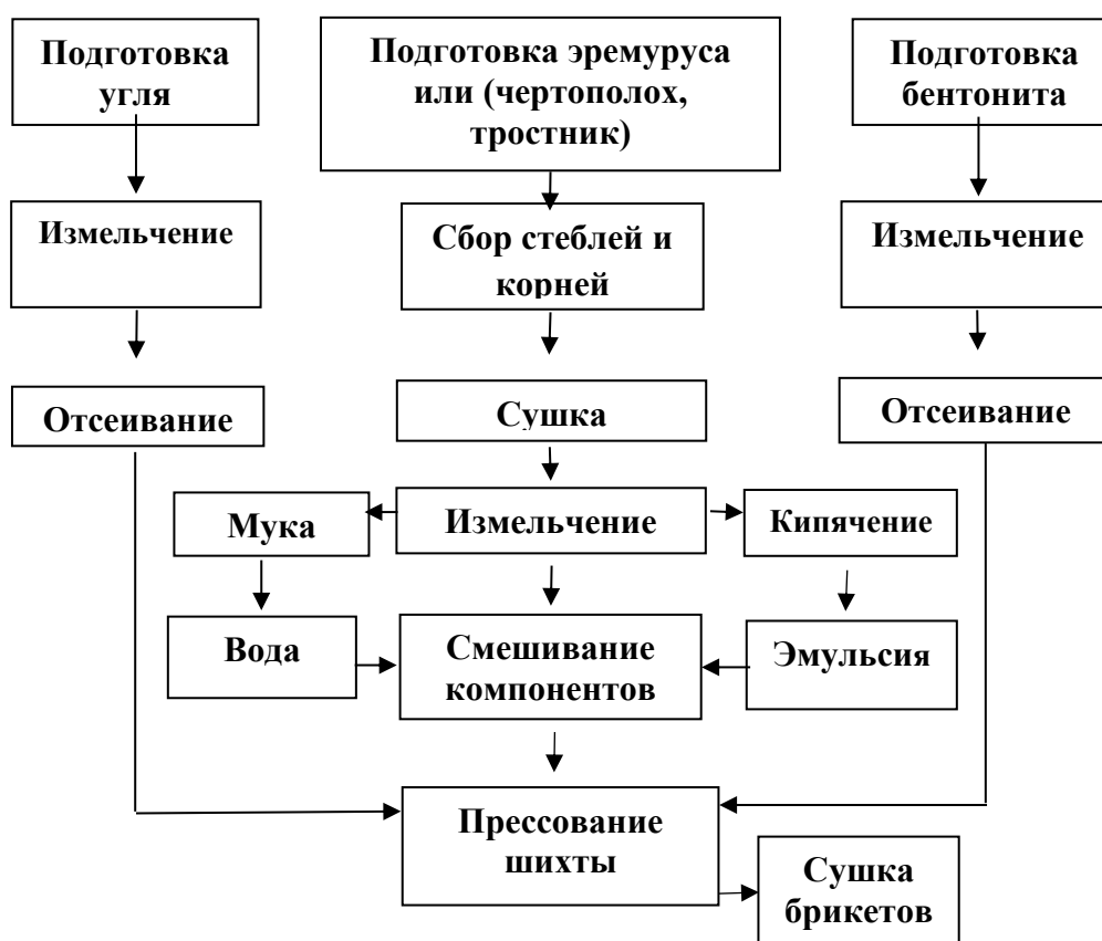
Рис.5. Блок-схема технологии получения угольных брикетов со связующими из продуктов переработки эремуруса, чертополоха и тростника с добавлением бентонитовой глины.
