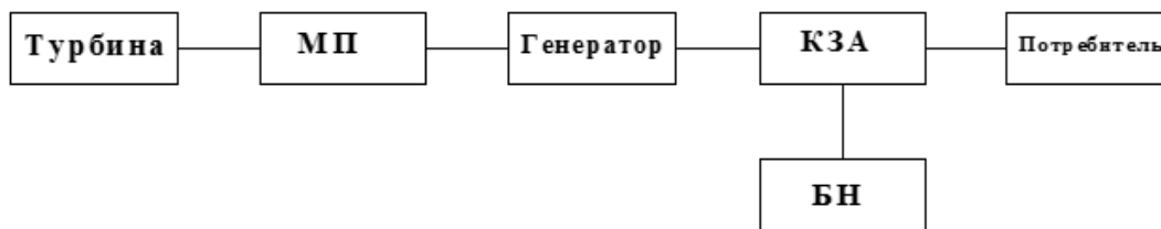
Рис. 1. Основные установки микро- ГЭС
