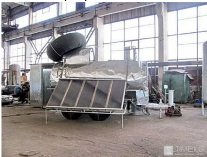
Рис.1 Гибридная биогазовая установка (с использованием солнечных батарей)
