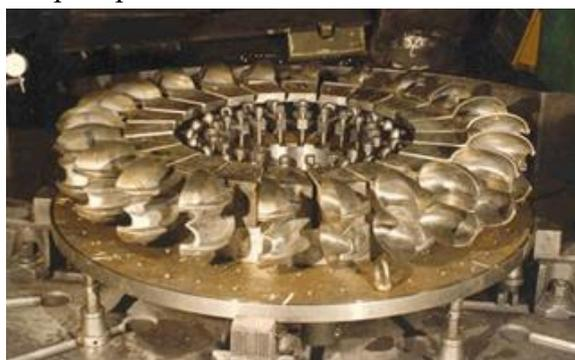
**Рис. 3. Гидроагрегат с ковшовой гидротурбиной**
