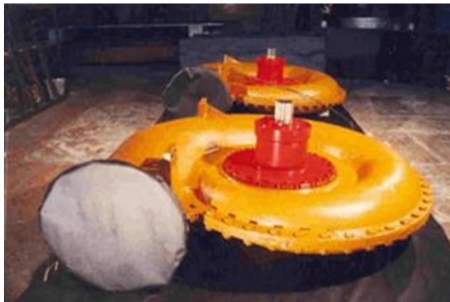
**Рис. 4. Гидроагрегаты с радиально-осевыми турбинами**
