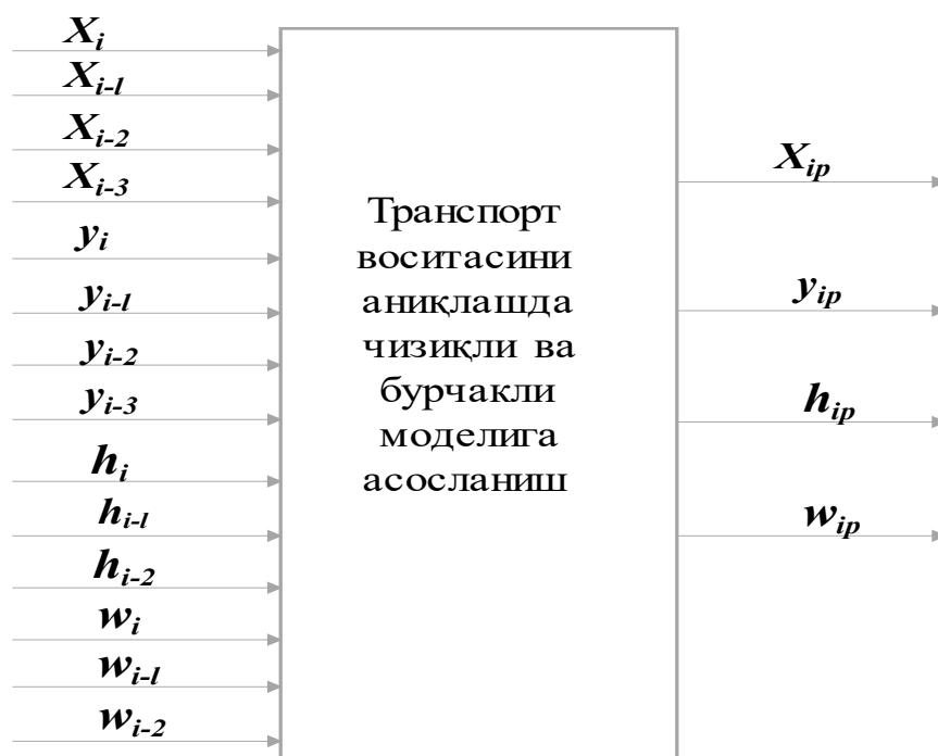
4-расм. Объектнинг чизиқли ва бурчак тезлигига асосланган ўрнини рўйхатга олиш учун математик моделнинг қора қутиси кўринишидаги схема.
