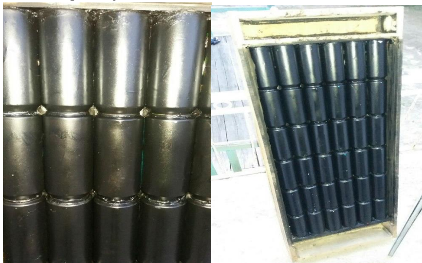
4-rasm. Quyosh xavo kollektorining qora jism yuzasini to'lqinsimon qilib bajarilganligi.
