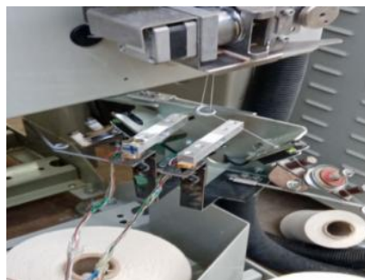
2-расм. . Тензодатчикни умумий кўриниши ва ўрнатилган нуқтаси.
