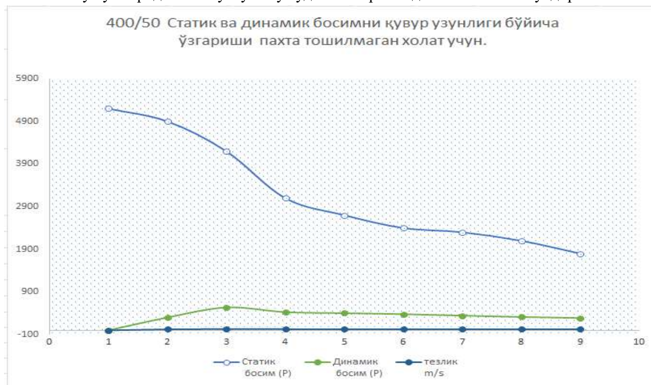
5- расмда статик ва динамик босимнинг тезликка нисбати келтирилган графиги келтирилган.
