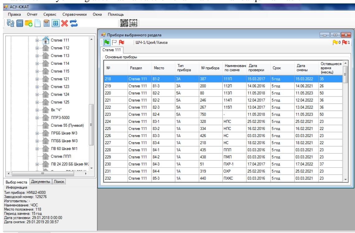
**Rasm 1. Temir yo'l avtomatika va telemexanika qurilmalarni avtomatlashtirilgan tizim orqali nazorat qilishning dasturiy interfeysi**
